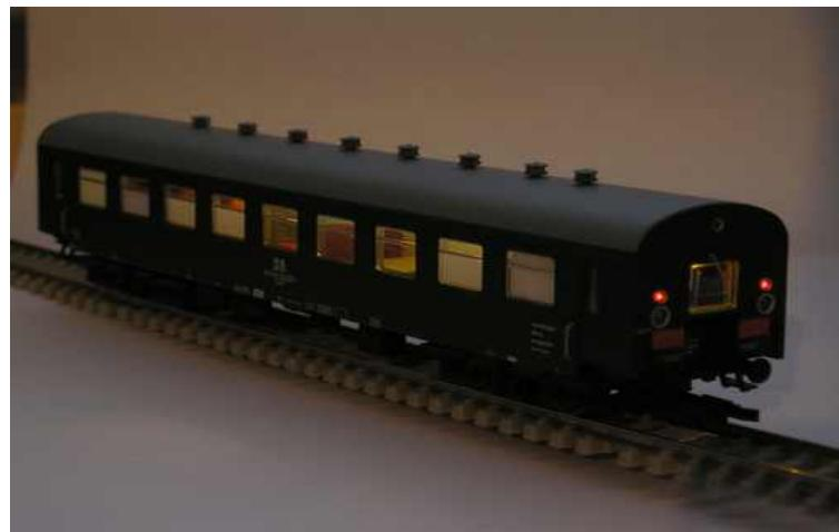
Der Wagenkasten wird über 4 Rosten des Bodens in den Fensterbändern (Nähe Drehgestellzapfen) gehalten. Zum Öffnen von unten den Wagenkasten in der Fuge zum Boden um ca. 0,3mm spreizen und dabei den Wagenkasten nach oben ziehen. Das Dach kann nun vorsichtig nach oben herausgedrückt werden.
